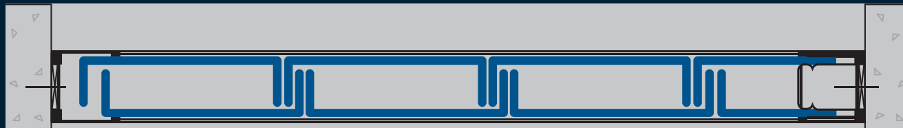
Схема вертикального монтажа стеклопрофилита
